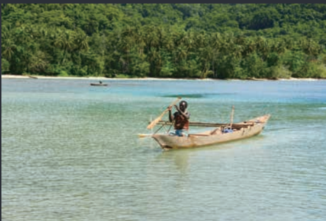
圖2 大洋洲常見的單邊帶架艇，圖中架艇型制和圖1的藏品雖略有不同，但基本結構是一致的，在主船身一側，以兩支木條連結一長型的舷外浮架。該圖攝於索羅門群島。（圖片來源：胡哲明攝，2013）
